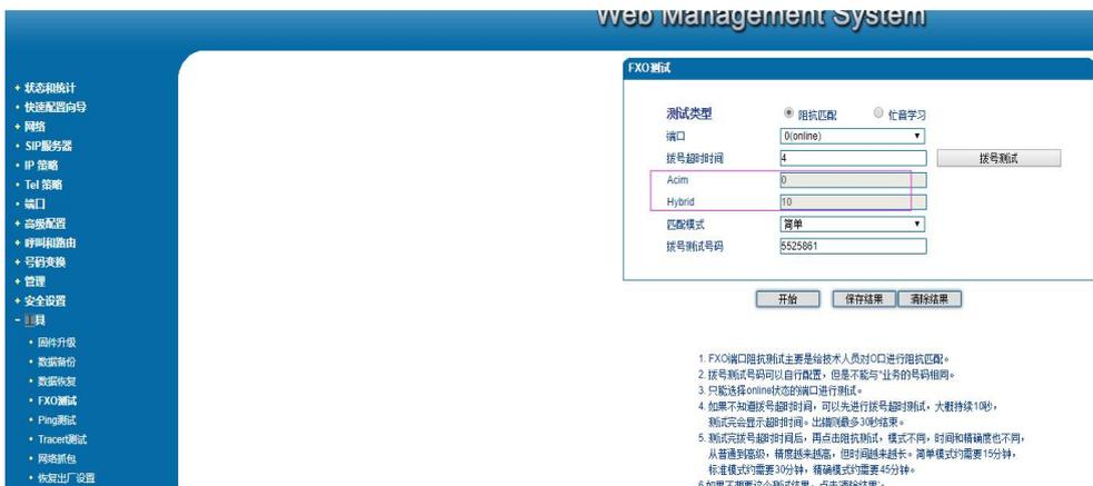
(4) 在 **高级配置-FXO 参数** 里面填写阻抗匹配的结果（如阻抗匹配中 acim 是 0, hybrid 是 10, fxo 参数处 acim 选择 (0), hybrid 手动输入 10），保存后下一通呼叫生效。
